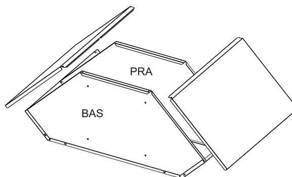
4º Encaixe o frontal nas laterais, parafuse com M4x6mm, Alinhe o tampo faceando com as laterais, fixe com parafuso tampo.
